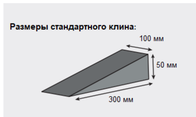
Изобр. 2. Установка клиньев и стандартные размеры клиньев
